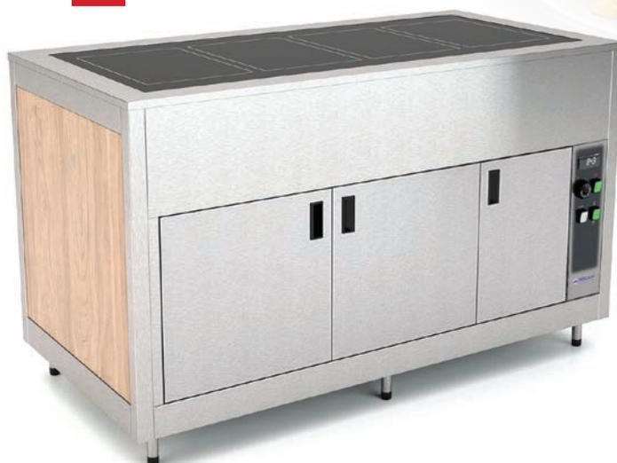
• Meuble chaud • Structure en acier inoxydable • Pieds de nivellement • 4 finitions de décors possibles • Chauffe par résistances en silicone • Étuve ventilée en partie inférieure • Thermostat électronique • Zones chauffées délimitées par des rainures périphériques (verre sablé)
