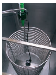
Cuve et serpentin inox
